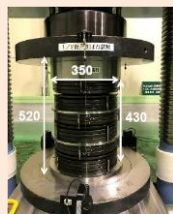
3次元免震装置／皿ばね試験体
