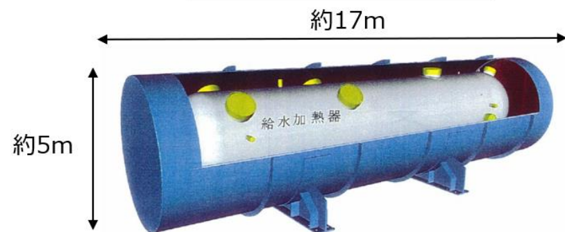
大型金属の例（給水加熱器）
