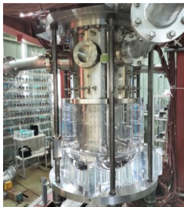
革新軽水炉の炉内流動試験 (三菱重工業株式会社)
