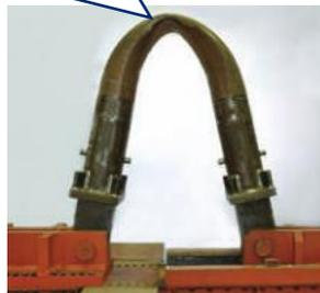
溶接接合鋼管の曲げ試験
