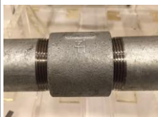
白ガス管の接合部
