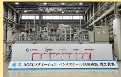
SOEC (大阪ガス) メタン製造10Nm 3 /h級
