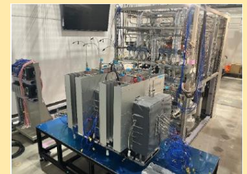
ハイブリッドサバティエ (東京ガス) メタン製造1Nm 3 /h級
