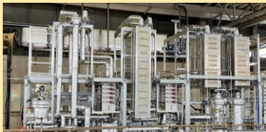
SOEC (大阪ガス) メタン製造0.1Nm 3 /h級
