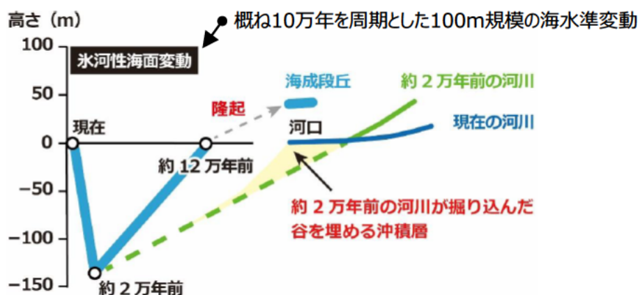
図 12 海水準変動に伴う侵食量と沖積層の基底深度
