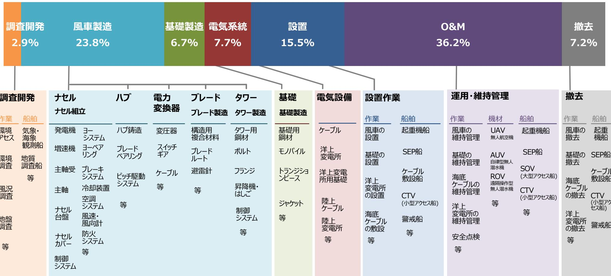
※数字（%）は「Guide to an offshore wind farm」(BVG associates, 2019)より三菱総研が算出したLCOEに占める割合。
