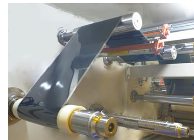
ロールtoロールによる製造
