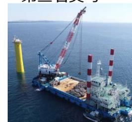
300t吊、全長61m、全幅23m、喫水-m
