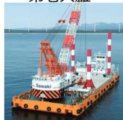
400t吊、全長65m、全幅25m、深さ4.5m
