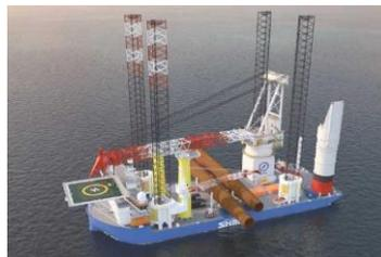
2,500t吊、全長142m、全幅50m、喫水6.2m
