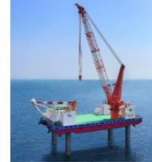
1,250t吊、全長88m、全幅40m、喫水4.6m
