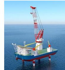
1600t吊、全長120m、全幅45m
