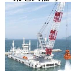
550t吊、全長74m、全幅25m、深さ4.8m
