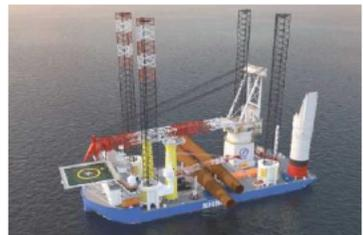
2,500t吊、全長142m、全幅50m、喫水6.2m
