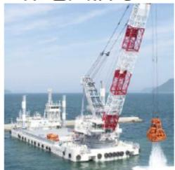
550t吊、全長74m、全幅25m、深さ4.8m
