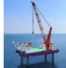
1,250t吊、全長88m、全幅40m、喫水4.6m
