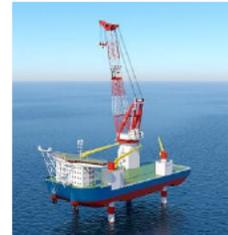
1600t吊、全長120m、全幅45m
