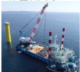
300t吊、全長61m、全幅23m、喫水-m
