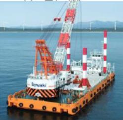
400t吊、全長65m、全幅25m、深さ4.5m
