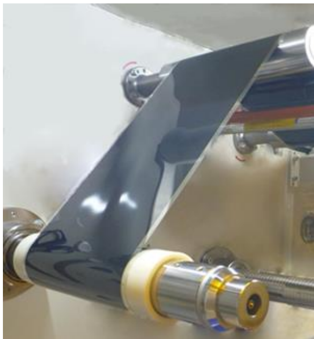
ロールtoロールによる製造
