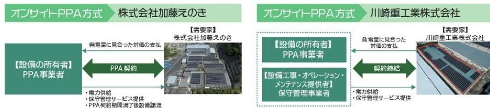
オンサイトPPAにより太陽光発電設備を設置。再エネ自家発電により日中の電力購入量が減ることで、デマンド値(30分間に消費された電力の平均値)を抑えることができ、電気の基本料金を削減できた。
