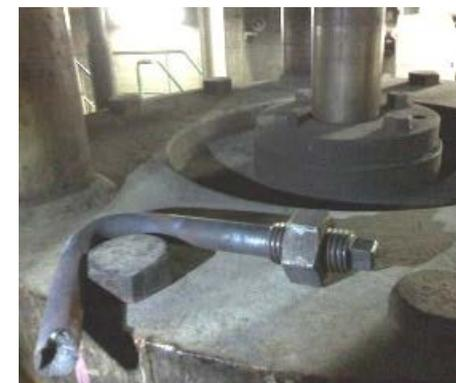
ボルト折損脱落状況
