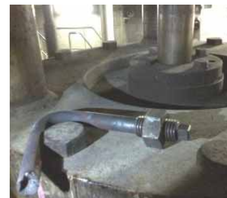
ボルト折損脱落状況
