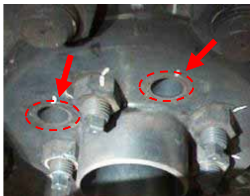
ボルト折損脱落状況
