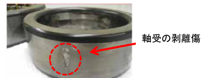
図 一次通風機の軸受け
