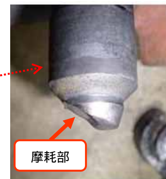
不具合状況 (弁内部部品摩耗)
