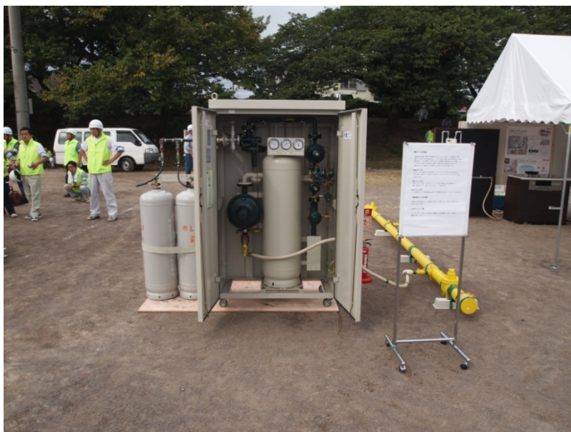
緊急時臨時供給用の移動式ガス発生設備×2基保有
