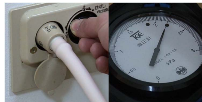
■ 圧力計による漏えい確認
