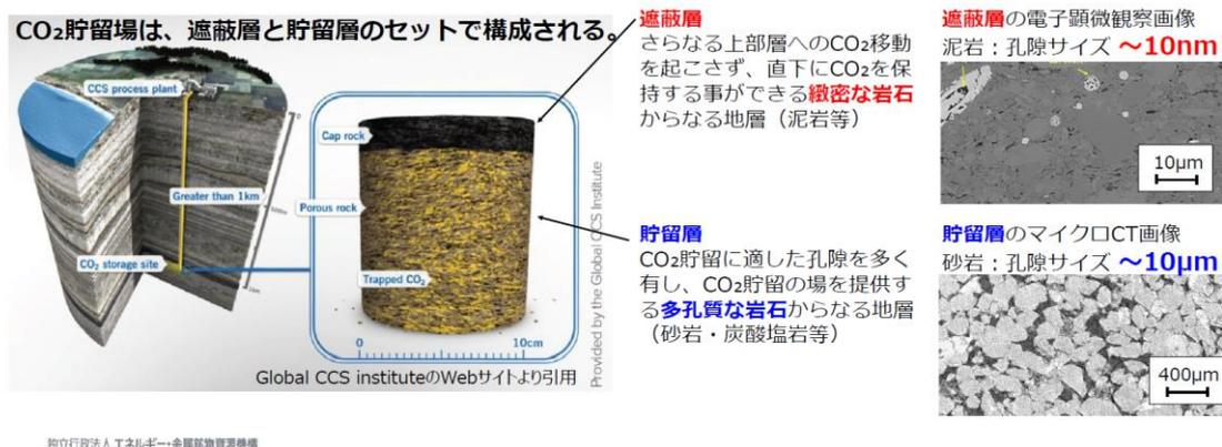
貯留されたCO<sub>2</sub>は、主として4つの貯留メカニズムにより、安定的に地中に貯留される（①構造的トラップ、②残留ガストラップ、③溶解トラップ、④鉱物化トラップ）。これらが異なる時間スケールで進行し、CO<sub>2</sub>の地中貯留からの経過時間が長くなるほど貯留は安定化へ向かう。
