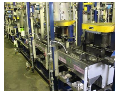
選鉱試験設備と浮遊選鉱の様子
