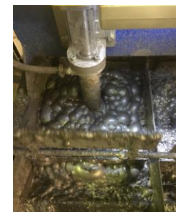
選鉱試験設備と浮遊選鉱の様子
