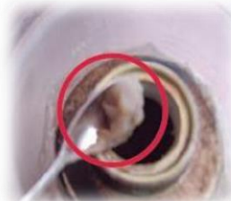
（燃料フィルターの目詰まり）
