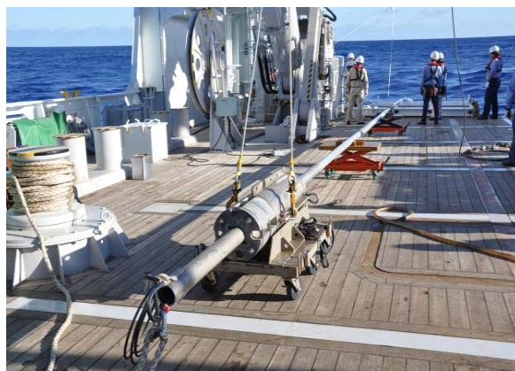
海底下の堆積物を採取する ピストンコアラ(全長20m)
