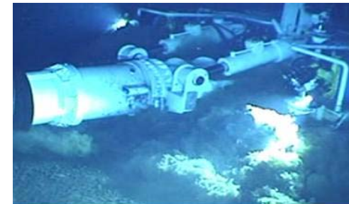
海底を走行・掘削する採掘試験機 (H24年8月 於、沖縄海域)
