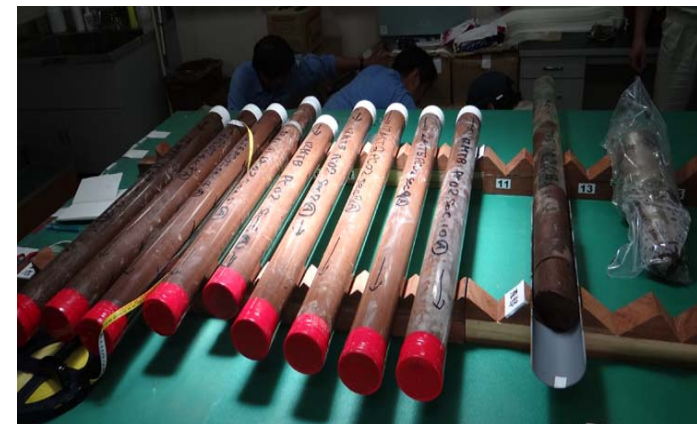
採取した海底下の柱状試料 (深度1mずつにカットしたもの)
