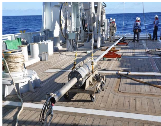
海底下の堆積物を採取する ピストンコアラ- (全長20m)
