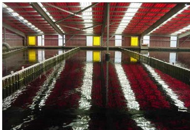
鉱石中の金属を酸などの水溶液に溶かして電氣的、化学的に金属を回収する製錬方法
