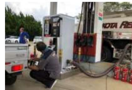
可搬式給油機等を利用した車両への給油
