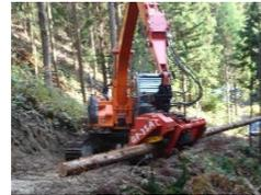
(写真は、枝払い、造材、集材作業を行うプロセッサ)
