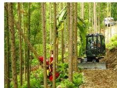
(写真は伐倒、枝払い、造材、集材作業を行うハーベスタ)
