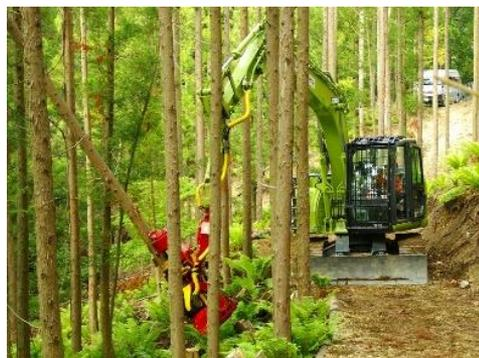
現在導入されている高性能林業機械は、伐倒、枝払い、造材、集材作業を一緒に行うハーベスタなどで伐採を行っており、区別することが困難
