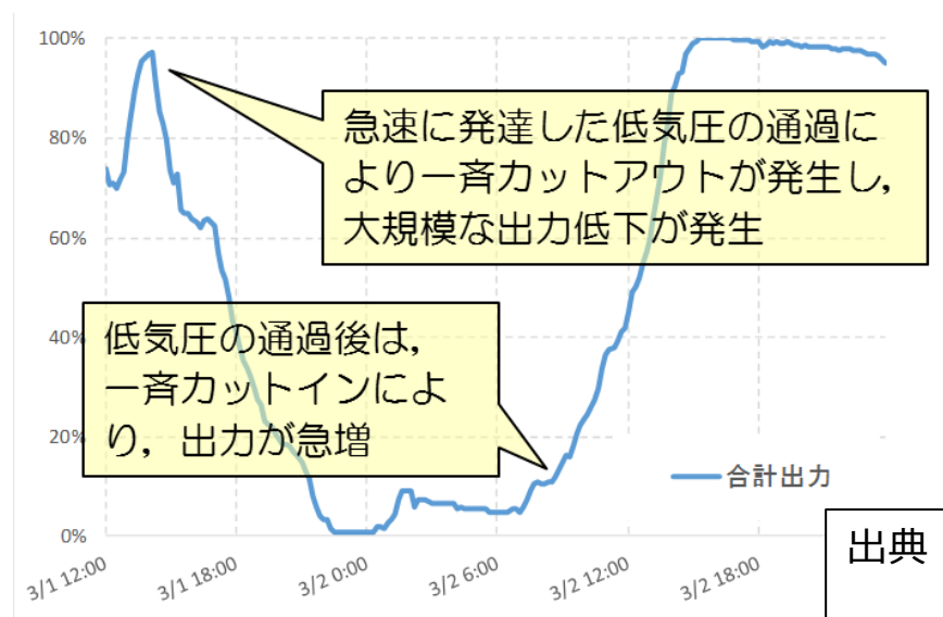
秋田県洋上風力の出力変動シミュレーション結果 (2018年3月1日、2日の風速を適用)
