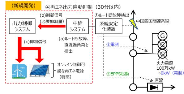
+25万kW (運用容量拡大分)を阿南紀北直流 幹線を活用し、緊急対応として四国エリア外へ送電
