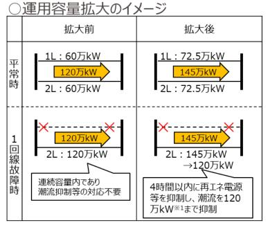
※1 作業停止等による1回線停止時は運用容量(熱容量)は 120万kW
