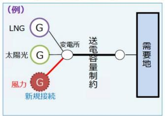
いくつかの実需給断面において送電 容量の超過が見込まれる場合、系 統が増強されるまでは**新規電源の** 接続を認めない。
