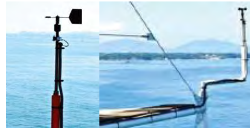
風況調査 (左:風向計、右:風速計)
