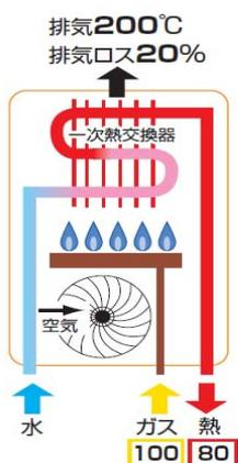
図2 従来型給湯器の構造
