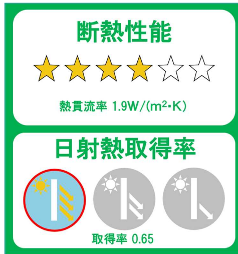
図 2.4-1 窓の性能表示のデザイン（縦表示）
