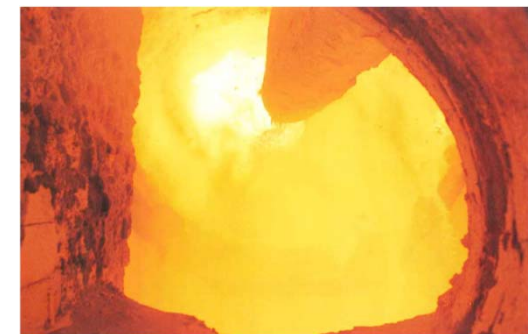
クリンカ焼成中の回転窯の内部
