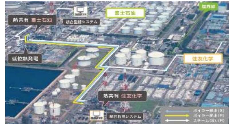
2工場間の廃熱輸送配管の状況
