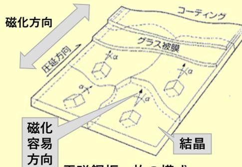
電磁鋼板一枚の構成
