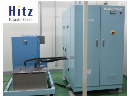
日立造船 プロトタイプ電解槽 in Toray
