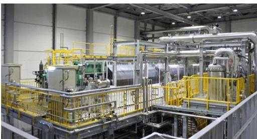
10MWの水電解装置
