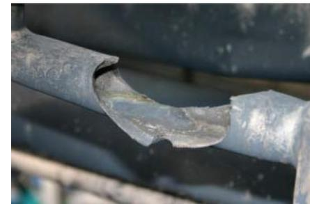
配管の圧力計取付部の破損状況
