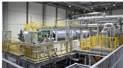
10MWの水電解装置
