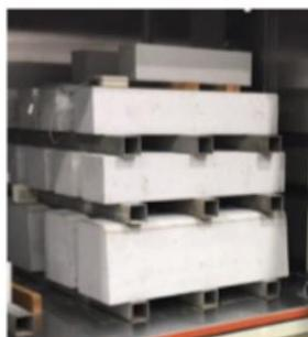
試験製造したCO<sub>2</sub>吸収コンクリート（地先境界ブロック）
