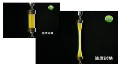
中圧導管の強度試験（例）
