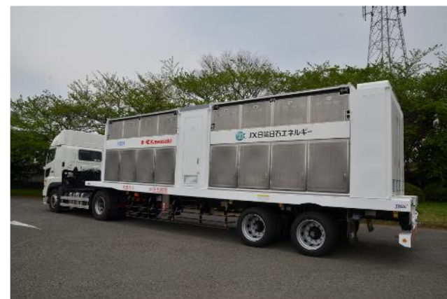
圧縮水素トレーラ
