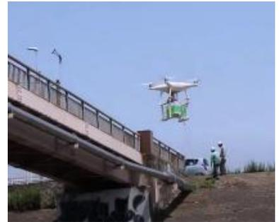
レーザーメタン等のセンサーを搭載し、検知結果をサーバーへ送信
