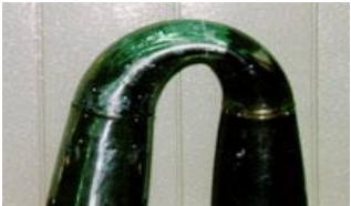
中圧導管の強度試験（例）
