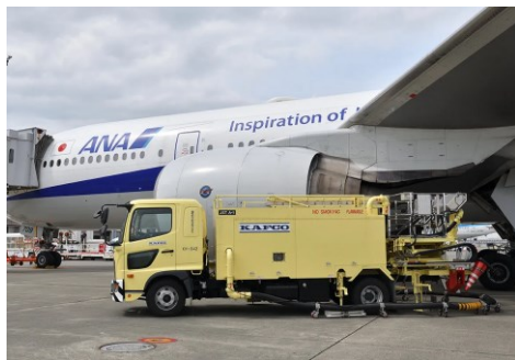
(貯蔵タンクなどから燃料を運搬)
