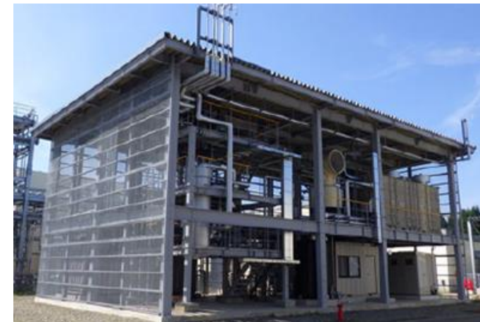
INPEX長岡鉦場に作られた8Nm 3 /h級のメタネーション試験装置
