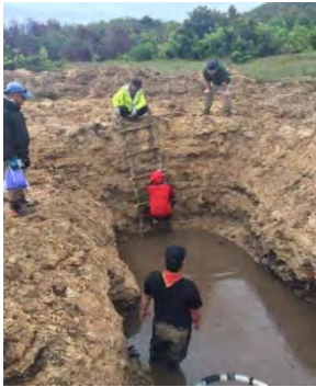
パラワン島のNAサイトでの粘土層のトレンチ調査
