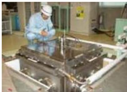
人工バリアシステムの健全性評価試験
