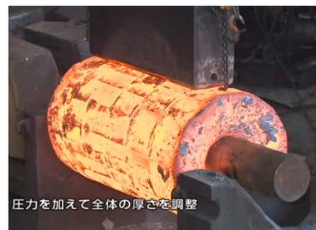
(a) 鍛鋼品の鍛造工程
