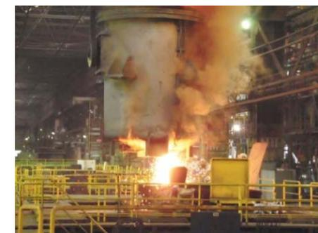
(b) 鍛鋼品の鋳込み工程
