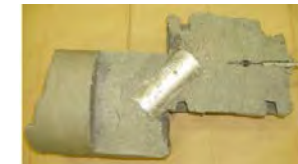
人工バリアせん断応答挙動 金属製オーバーパックは損傷や変形は認められなかった。
