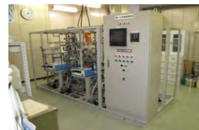
膜分離工学試験装置
