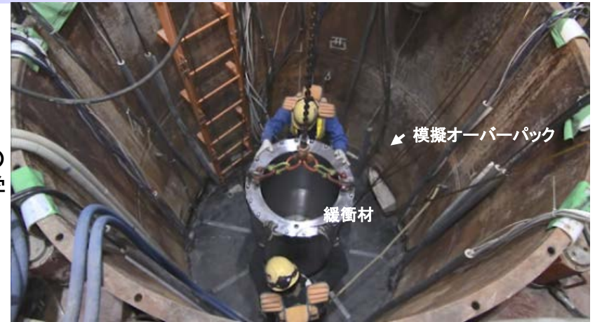
人工バリア性能確認試験：模擬オーバーパックの設置
