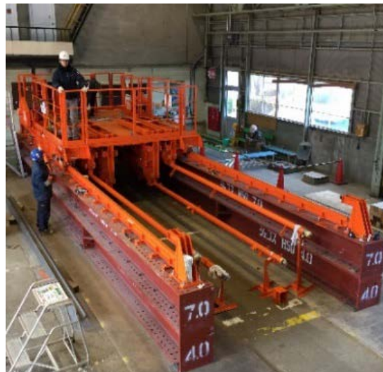
スクリュー方式による埋め戻し材の施工
