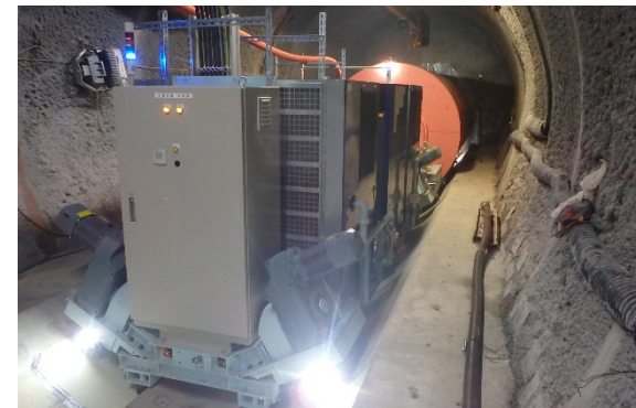
エアベアリング方要素による搬送試験
